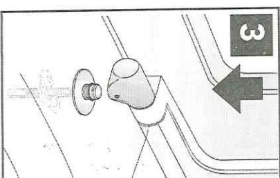
Visser manuallement les goussets en les tenant soulevés de façon que le blocage "orizon" soit en butée avec la céramique et donc bloqué. Serrer sans bloquer complètement, les goussets doivent pouvoir bouger sur le plan de l'appareil sanitaire.
